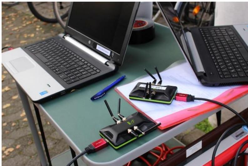
Einfaches Setup mit zwei LimeSDRs im Vordergrund
