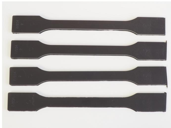
Abbildung 1.2: Vier Polypropylen-Zugstäbe mit Rezyklatgehalt 0%
