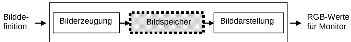
Abb. 11.1: Hauptkomponenten eines Rasterdisplays
