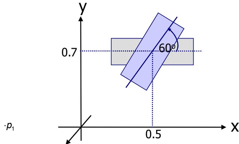
3. Rücktransformation in die Originalposition      2. Rotation um die Z-Achse      1. Transformation in den Ursprung
