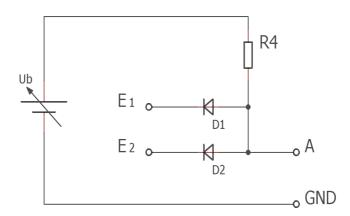
Experimentieren Sie mit dieser Schaltung indem Sie die unten stehende Tabelle vervollständigen. Verwenden Sie bitte für die Beschaltung der Eingänge  $E_1$  und  $E_2$  die Eingabetastatur des Digi-Board.
